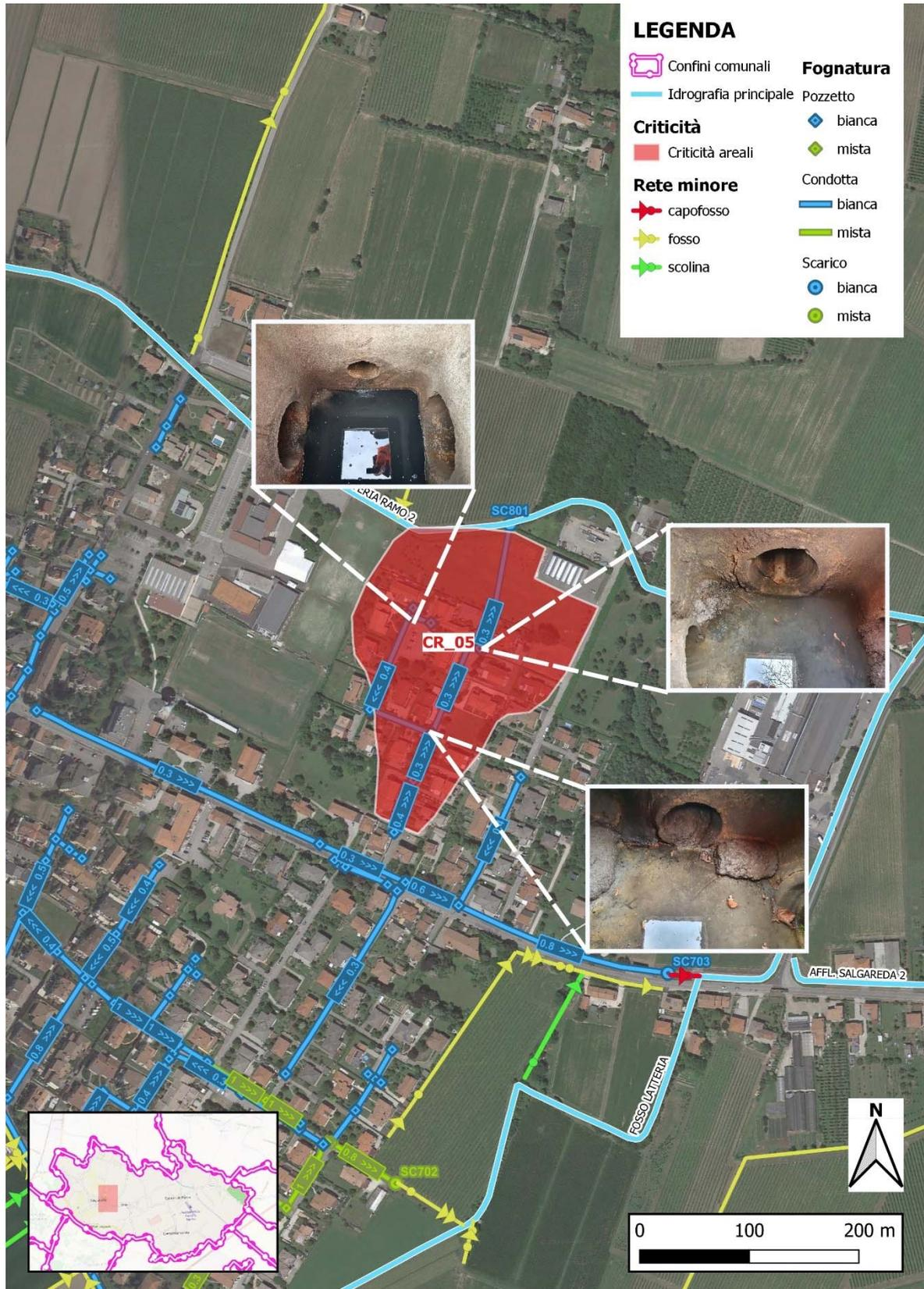
Figura 6-F. Allagamenti di area urbanizzata per insufficienza della rete fognaria esistente
