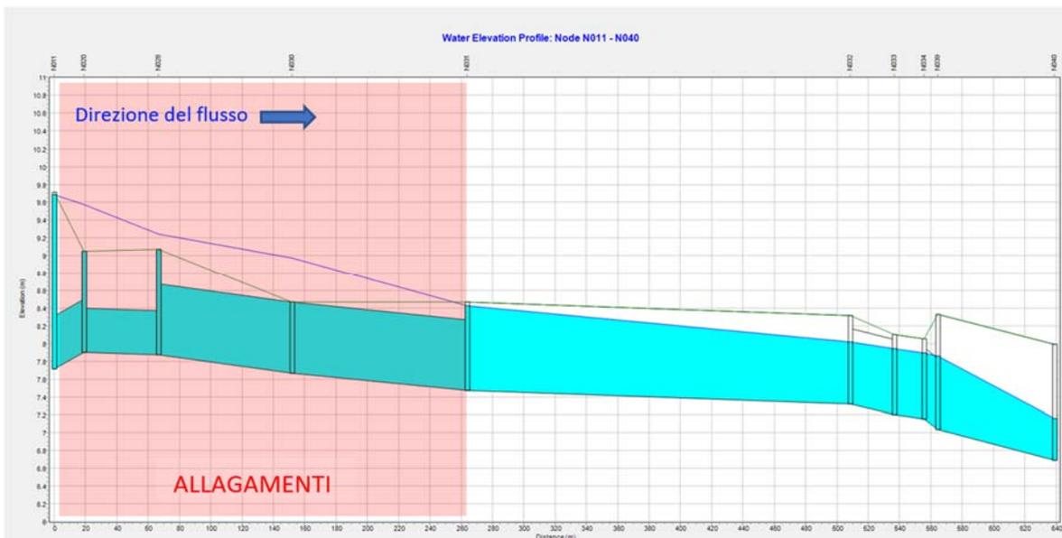
Figura B. 13: Profilo longitudinale parte 2 ( $t_p=3$  ore,  $Tr = 50$  anni).
